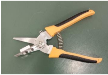
8mm専用カット用はさみ 2mm/4mmピッチ兼用
